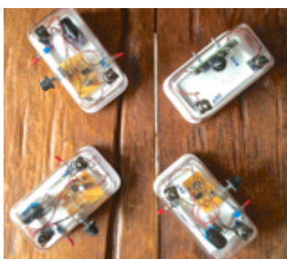
Lutherie électronique, 2016, installation sonore, quatre mini mapli fondés sur le lm386.
